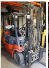
TOYOTA MODEL 7FGCU32, 5500 LB CAPACITY, LPG, 3 STAGE MAST, SIDE SHIFT,
