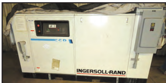
INGERSOLL - RAND SSR - EP100 Air Compressor
